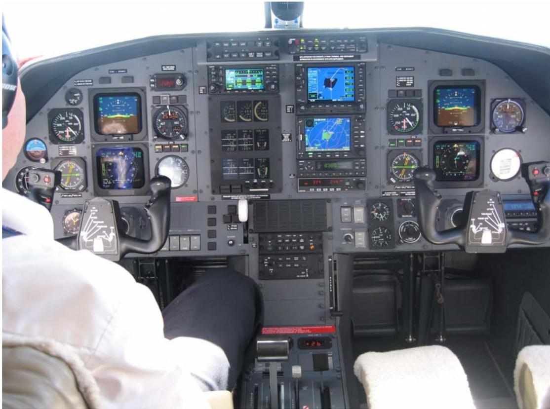
Auch das Cockpit lässt keine Wünsche offen: Beidseitiges „Glasscockpit“, Doppeltes GPS, TCAS, Wetterradar, Stormscope, Terrain Warning System, vollwertige Enteisung, vollautomatische Druckkabine und Aircondition, ein Autopilot, der alle Stückerln spielt, zwei Generatoren und eine Sprit-Notversorgung für die Turbine, falls einmal die Fuel Control Unit eingeht....
