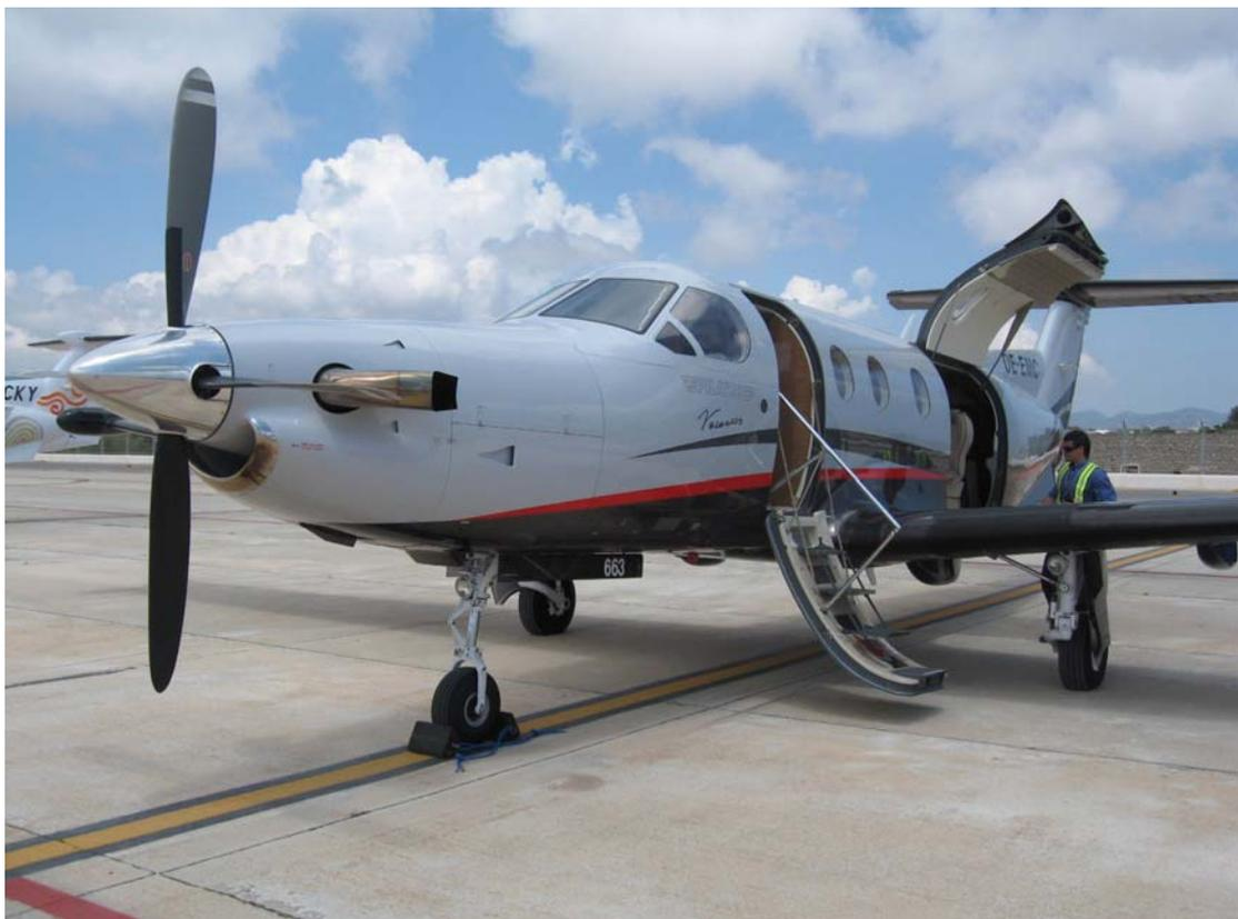
Gleich der erste optische Eindruck ist begeisternd: Hier ist den Schweizern ein großer Wurf im wahrsten Sinn des Wortes gelungen. Die Maschine sieht nicht nur groß aus, sie ist es auch. 14 Meter lang, Spannweite 16 Meter und eine Leitwerkshöhe von über 4 Meter sind beeindruckende Maße. Hier wurden Nägel mit Köpfen gemacht.
